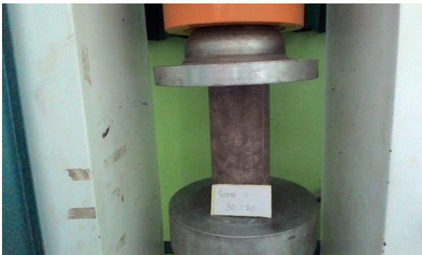
Uji kuat tekan beton
